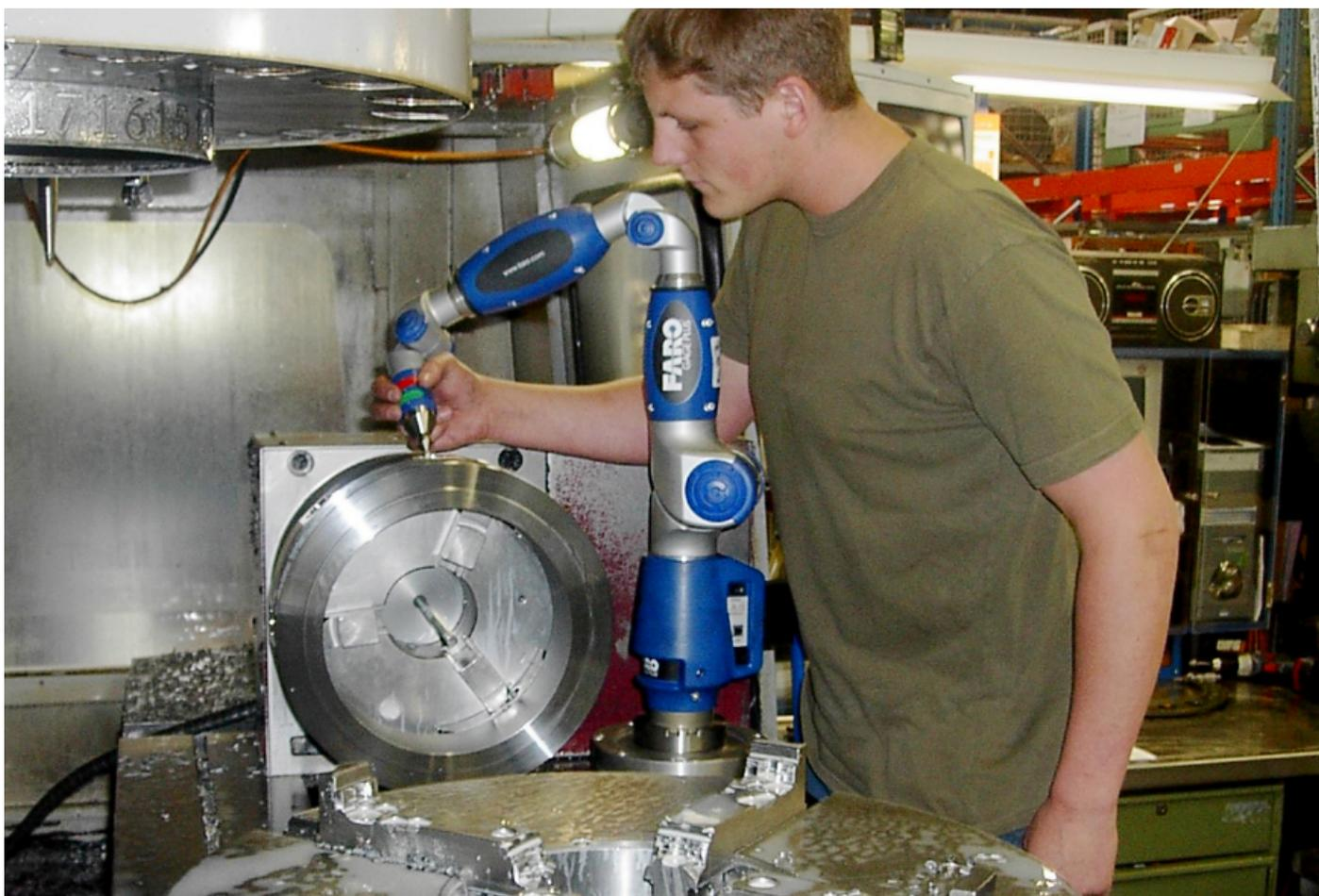
*Die FARO Gage in der Maschine auf einem Bearbeitungszentrum*
