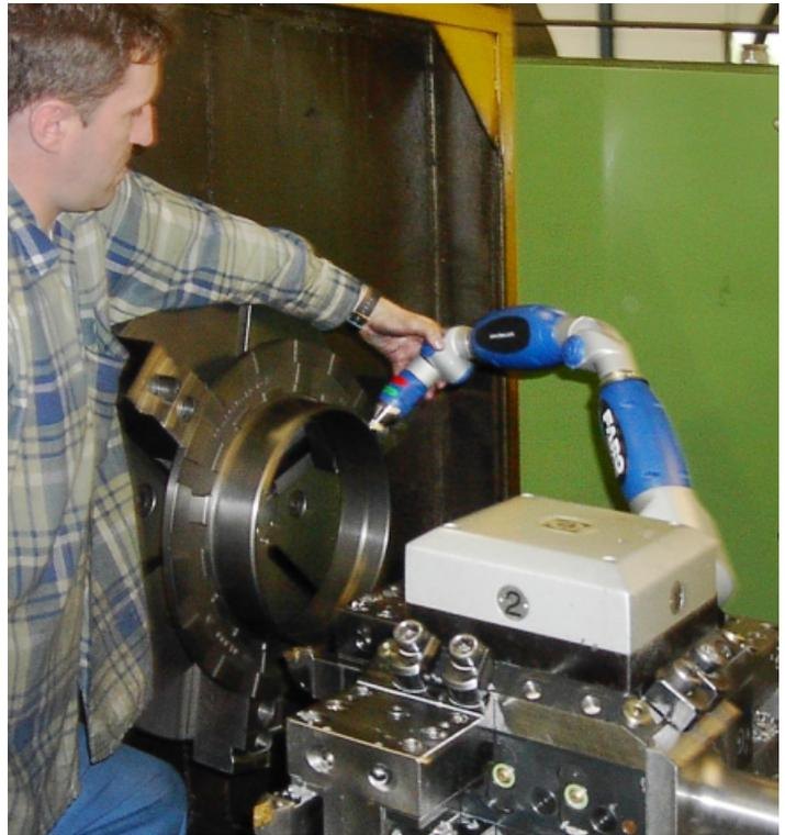
*Messen auf einer Drehmaschine*
